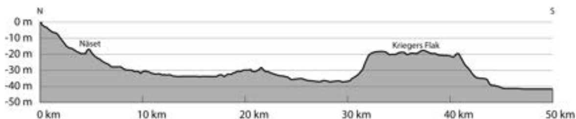
FIGUR 14. Nordsydgående bottenprofil från Skåre, utmed kabelkorridoren och över Kriegers flak. Djupdata från Emodnet Bathymetry. Bearbetad av Arne Sjöström.
