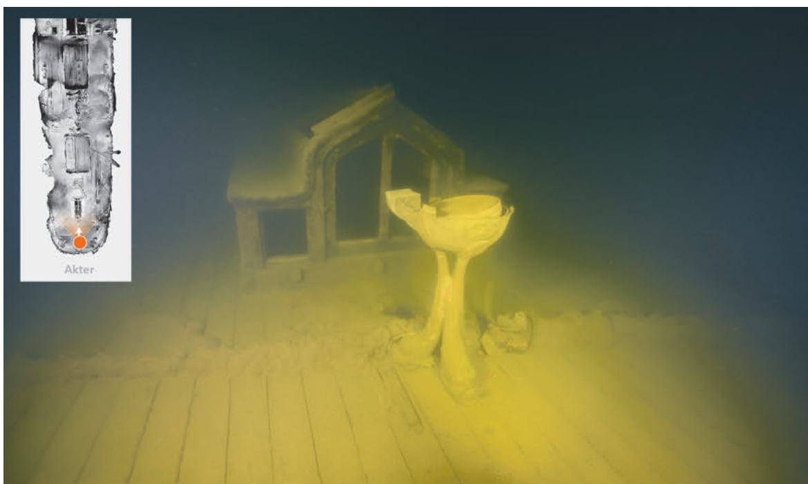
FIGUR 30. Kompassstativ med fiskfötter. Kompassen intakt inkl. glaset. I bakgrunden syns däckshuset.
