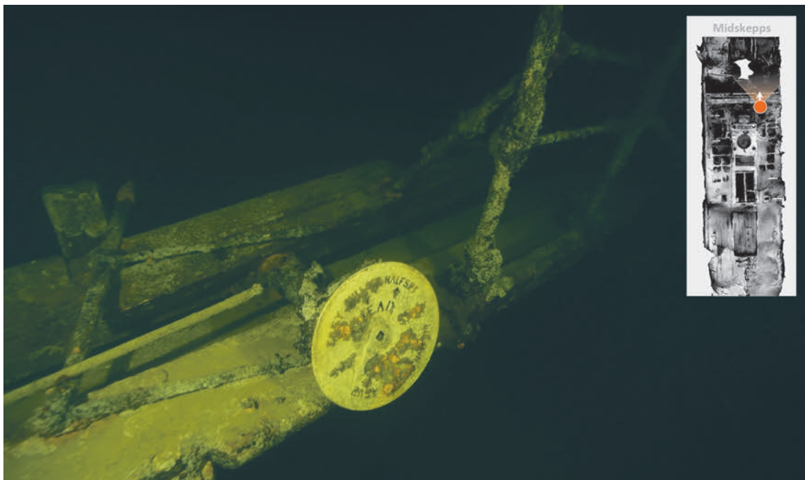
FIGUR 26. Maskintelegraf som ligger ned på bryggan över styrhytten. Notera texten och pilen som står på "Easy". Foto: Mikael Fredholm, SMTM (Digitalt museum: VK.V 0176). Infälld bild: Alexander Rauscher (layout).
