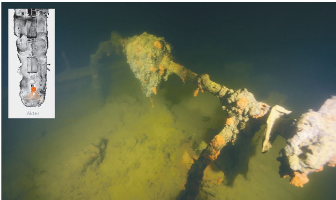
FIGUR 29. Reservratt. Endast rattstativet och rattnavet är kvar.
