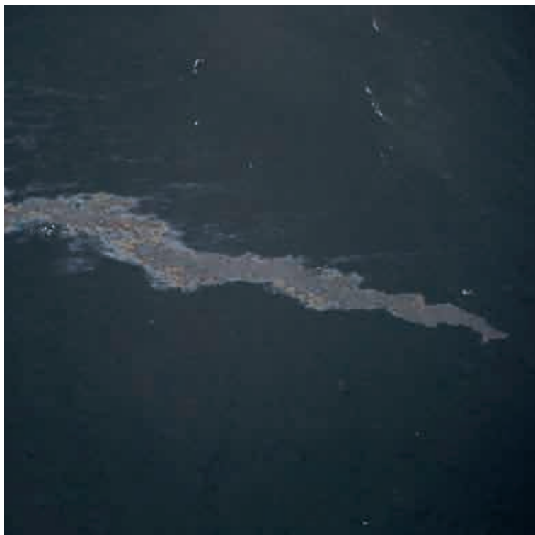
Den 31 oktober 2006 lämnade Finnbirch Helsingfors för resa till Århus. Fartyget förliste i mycket hårt väder öster om Öland på grund av en förskjutning i lasten ombord. Under 2019 och 2020 har två bärgningsoperationer av olja letts av svenska Havs- och vattenmyndigheten. Finnbirch , som ligger på 82 meters djup, har tömts på 148,2 kubikmeter miljöfarlig olja. Fotot visar oljeutsläpp från fartyget.
