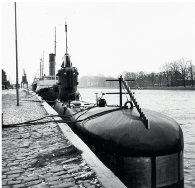
Ubåtsnät var ett försök att stoppa ubåtar från att tränga in i områden som skulle skyddas, exempelvis hamnar. Men som fallet ofta är i militära sammanhang så föder medel motmedel. För att försöka ta sig igenom ubåtsnät så utrustades ubåtar med nåtsågar. Ubåten Makrillen med nåtsåg i fören i slutet av 1960-talet.
