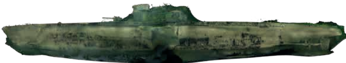
3D-modell av U-479 . Vraket ligger med 90 graders slagsida på drygt 90 meters djup i Finska viken. Det har spår av en kraftig explosion i skrovet vid kommandotornet, troligen orsakad av en mina.
